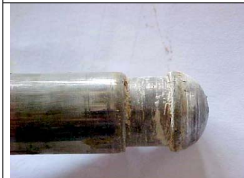
Foto 8: Incrustação dura na haste do suporte do disco da PSV-601, desmontada da guia, com auxílio de prensa hidráulica.
