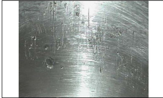
Foto 5: arranhões e mossas no êmbolo da válvula principal da SP-31 (modelo piloto operada JPV).
