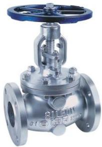
**Globo:** são válvulas utilizadas para controle e bloqueio de fluxo. Para controle elas devem ser utilizadas para aplicações até 20% de pressão diferencial ou 150 psi, o que for menor. Podem ser construídas com diversos tipos de obturadores (com ou sem pino guia) e com sedes metálicas ou resilientes, além de diversos materiais para o corpo, castelo e componentes internos, para aplicações corrosivas ou não corrosivas, são unidirecionais quanto ao sentido de fluxo.
